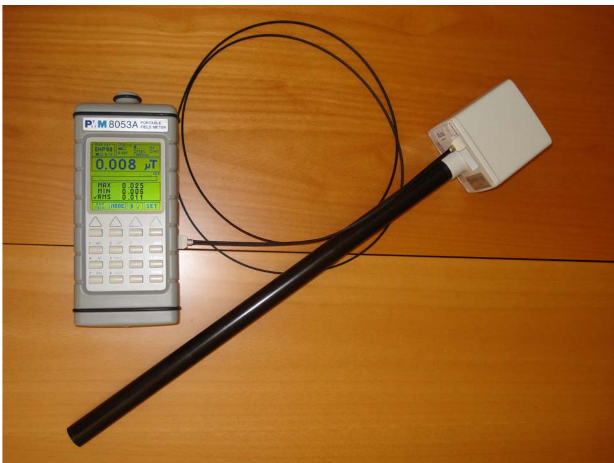
Abb. 3: Messequipment. Das Messgerät PMM 8053A mit der Antenne EHP 50.
