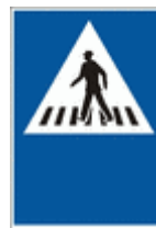
4.11L Standort eines Fussgängerstreifens
