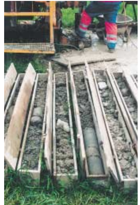
Die Bohrkern zeigen, wo der Boden durchlässig ist und wo nicht
