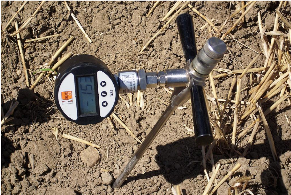
Abb. 24 > Messung mit schnell ansprechendem Tensiometer
