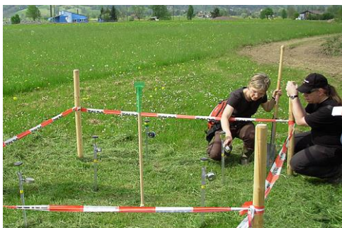
Abb. 25 > Temporäre Messfläche mit 5 Tensiometern auf einer Baustelle im St. Galler Rheintal
