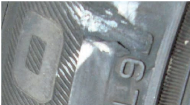
Kleine Schrammen, Stahlchord und Abdecklage nicht sichtbar.
