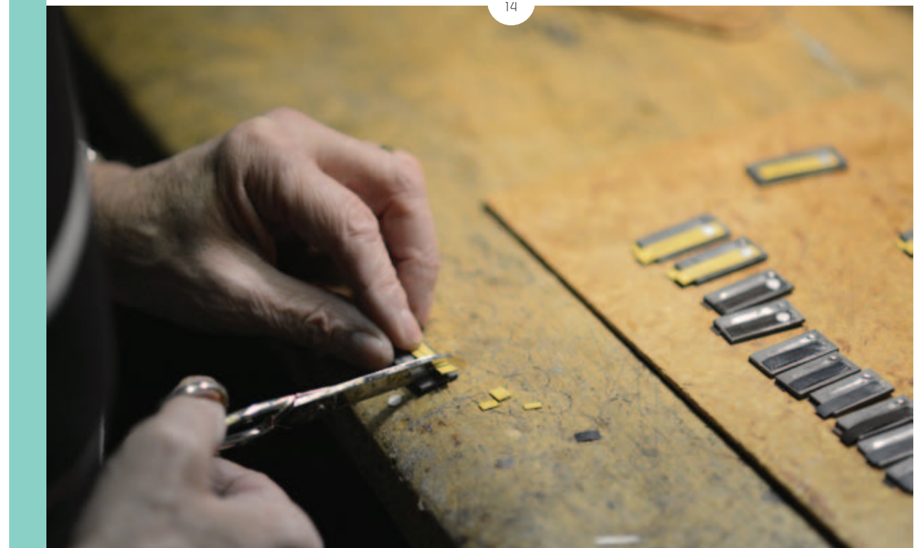
OBEN/LINKS UNTEN: Werner Greuter bearbeitet die „Zünglein an der Zarge“, damit sie den richtigen Ton geben. LINKS OBEN: Christian Greuter richtet derweil die Klappenmechanik.
