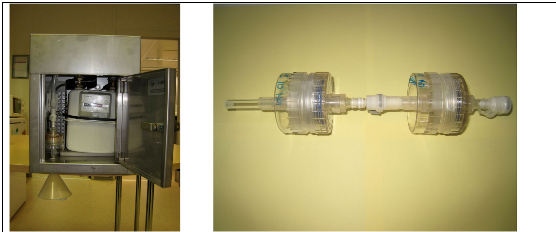
Abbildung 38 links: Offener Suffix, rechts: Summenfilter und Kontrollsummenfilter in Serie Probeneinlass, Summenfilter, ev. Kontrollsummenfilter, Gasuhr, Rotameter und Pumpe
