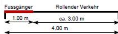
Abb. 3: In Arbeitsgruppe diskutierte Gestaltungsvarianten zur Optimierung Sägelstrasse (schwarz: bestehende Strasse, rot: Neuanlage)
