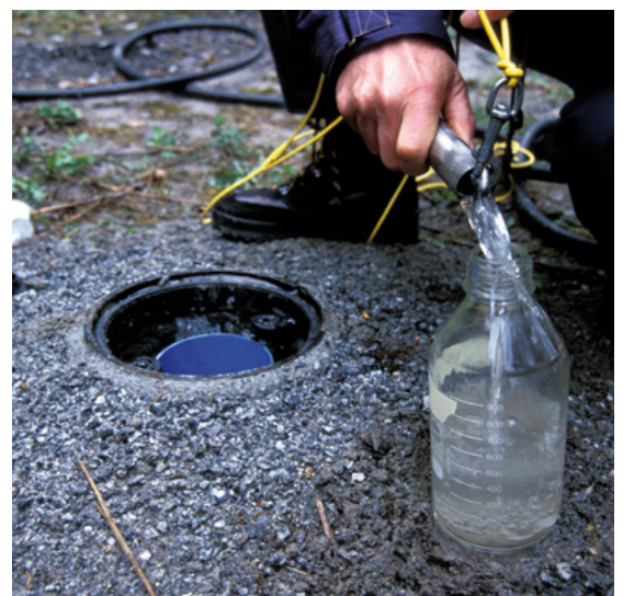
Grundwasserproben-Aufnahme Bild: BAFU, Emanuel Ammon
