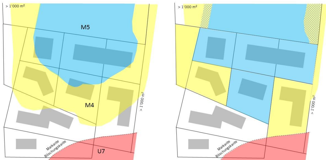
Abb. F.1: Umsetzung von Gefahrenkarten in den Zonenplan (Beispiel schematisch).
