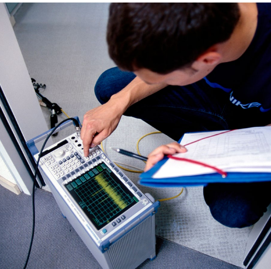
Beim Messen der Strahlenbelastung einer adaptiven Antenne kann neu ein Korrekturfaktor eingesetzt werden. Bild: Emanuel Ammon/BAFU
