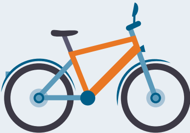
Diamantrahmen sind sehr stabil gebaut
