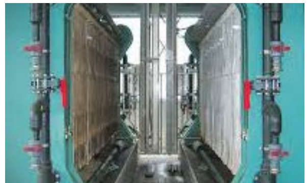
Abbildung 37: Bandfilterpresse der Fa. Huber Picatech (links) und Kammerfilterpresse von Diemme® Filtration, Aqseptence Group (rechts)
