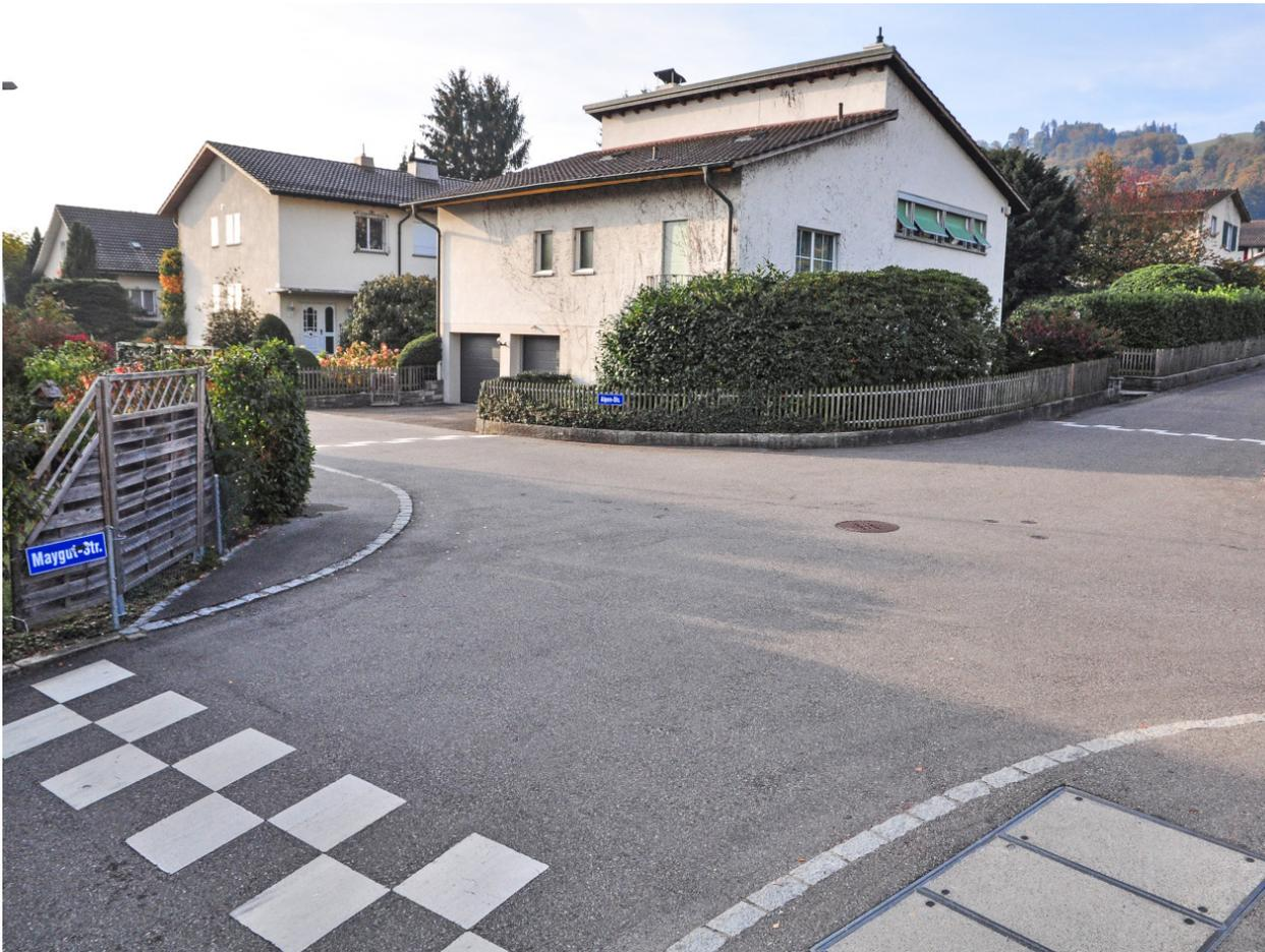
Abbildung 13: Vertikalversatz als Aufpflasterung einer ganzen Kreuzung
