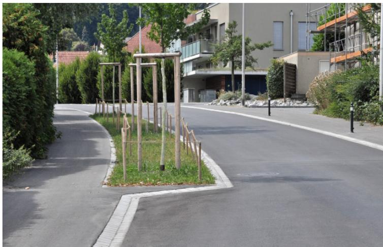
Abbildung 14: Seitliche Einengung mit Einbezug des Fahrbahnrandes
