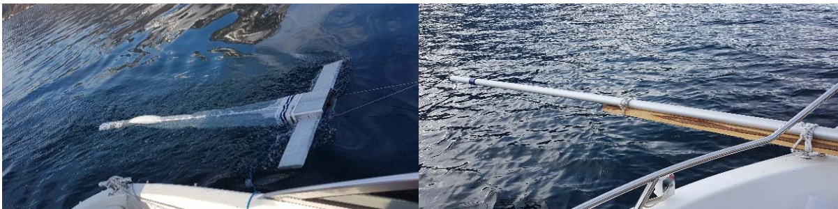
Abb. 1: Mantanetz auf dem Wasserkörper während der Probenahme (links). Während der Probenahme wird das Netz in einem bestimmten Abstand vom Schiff gehalten, so dass das Schiff die Strömung direkt am Netz nicht negativ beeinflusst (rechts).
