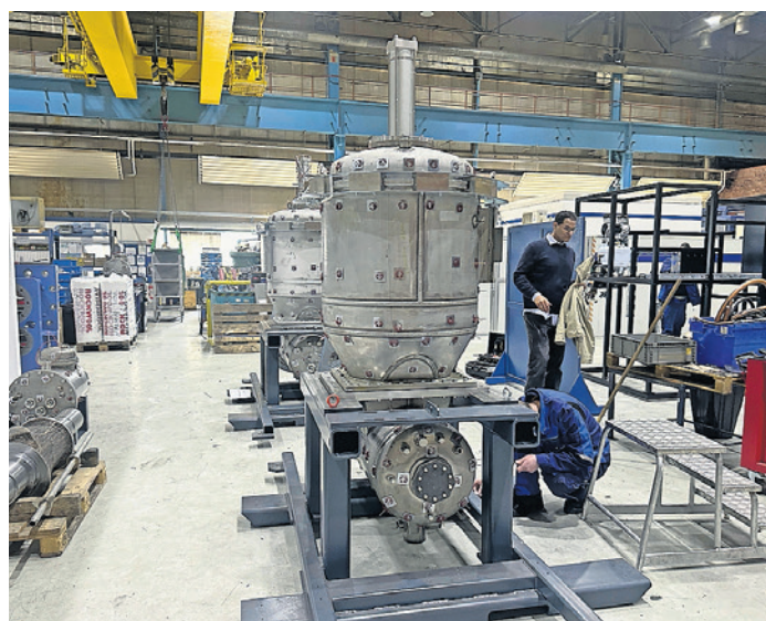
Komponenten des «Medi Steam» in der Produktion. Die Anlage sterilisiert medizinische Abfälle und macht sie sicher entsorgbar.
