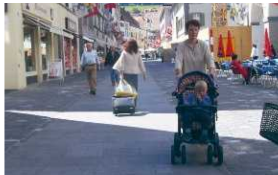
Der Plattenbelag in der Mitte der gepflästerten Altstadtgasse reduziert den Rollwiderstand und wird darum nicht nur von Menschen mit Behinderung, sondern auch von Personen mit Kinderwagen und Rollkoffer geschätzt.
