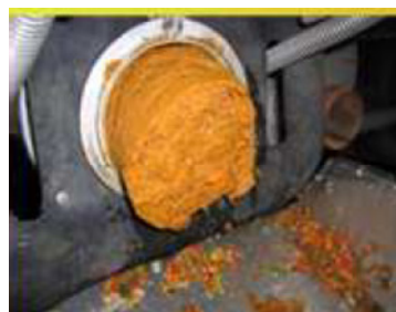
Abbildung 42 Siebrückstand von Spinat (links) und entwässertes Karottenschlamm (rechts) (Photo: Fa. Salsnes).
