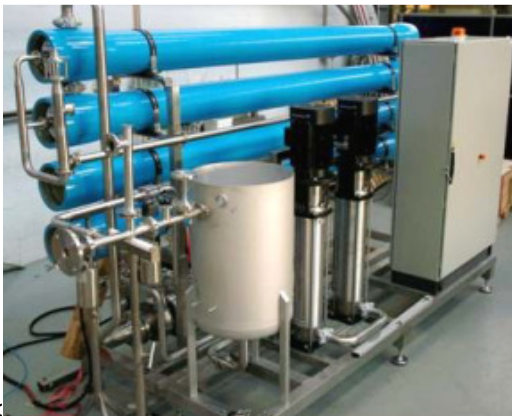
Abbildung 31 Einsatz einer Nanofiltrationsanlage (Anlage der MMS AG).
