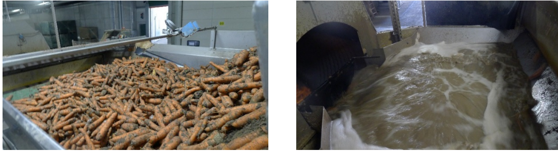
Abbildung 17 Mit Schmutz behaftete Karotten sorgen beim Prozess Rüsten für erdhaltige Abwässer.
