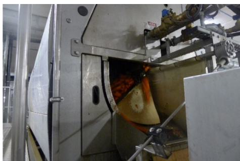
Abbildung 10 Maschinelles Waschen (Karotten in Waschtrommel) versus manuelles Waschen.
