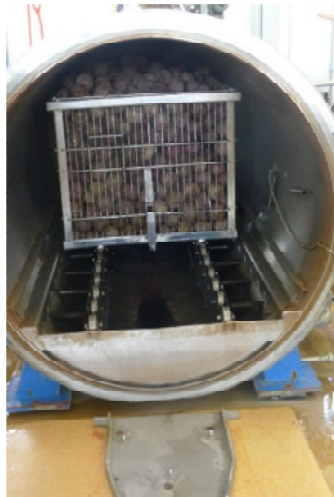
Abbildung 14 Links: Garen unter direktem Kontakt mit Dampf (Randen). Rechts: Kochen in der Verpackung ohne direkten Kontakt vom Dampf mit dem Produkt (Kartoffeln).
