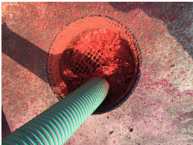
Abbildung 15 Organisch hoch belastetes Abwasser bzw. flüssiger Abfall (hier: Garwasser aus Randerzeugung) wird einer Vergärung zugegeben.
