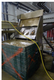
Abbildung 39 Bogensieb zum Entfernen von Feststoffen nach Rüsten von Karotten.
