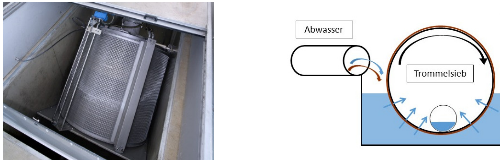
Abbildung 40 Siebtrommel zur Abscheidung von Feststoffen (Anlage der Fa. Huber Picatech).
