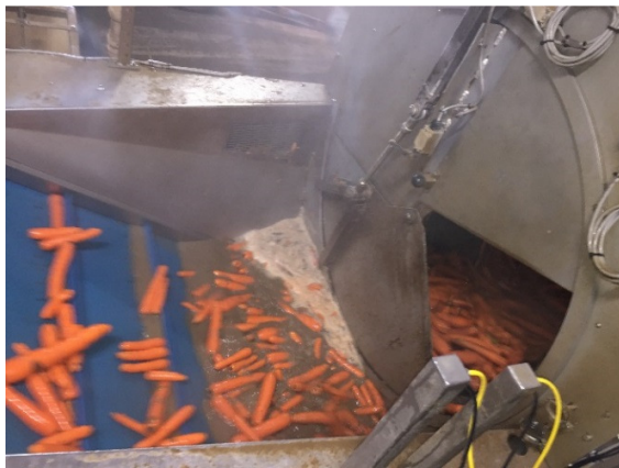
Abbildung 9 Rohprodukte (Karotten) werden in einer Drehtrommel im Wasserbad gerüstet. Der gegenseitige Abrieb erzeugt eine saubere und geglättete Oberfläche.
