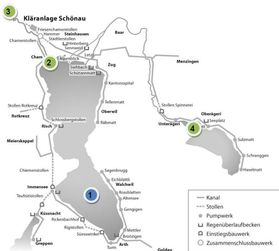
Abbildung 3: Probenahmepunkte für Messkampagne: (1) Tiefenprofil im oberen Becken des Zugersees, (2) Auslauf Zugersee, (3) Lorze unterhalb ARA Schönau und (4) Ägerisee.
